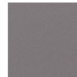
SOLITEX en même grossissement microscopique membrane monolithique sans pores= étanchéité maximale à la pluie battante
