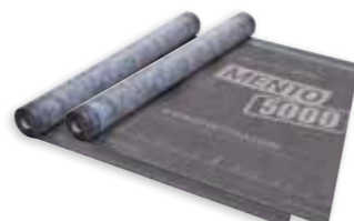
SOLITEX MENTO 5000 écran de sous-toiture triple couche lourd, résistant aux intempéries 6 mois.
