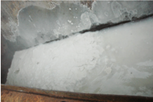
Extinction ordinaire : La chaux vive est jetée dans une quantité d'eau convenable Gare aux projections !
