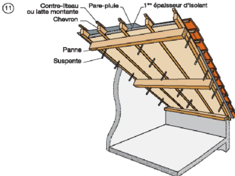
3-2-2-2. Pose de la première couche d'isolant entre solives (schéma n°11) :
