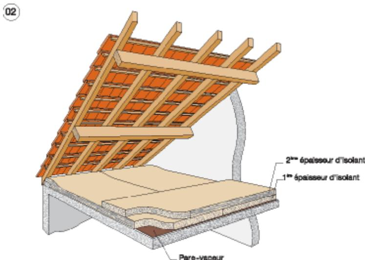
L'isolant ne doit pas obstruer les bouches de ventilation et ne doit pas être en contact avec des sources chaudes, écart au feu 17 cm au minimum (conduit de cheminée, lampes,...).
