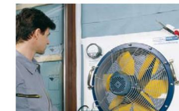
Lorsque tous les raccords sont réalisés, nous recommandons de vérifier l'étanchéité à l'air en mesurant la pression différentielle, à l'aide d'un test BLOWER DOOR ou d'un appareil de contrôle pro clima WINCON.
