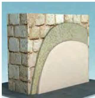
Enduit isolant en deux couches sur maçonnerie pierre
