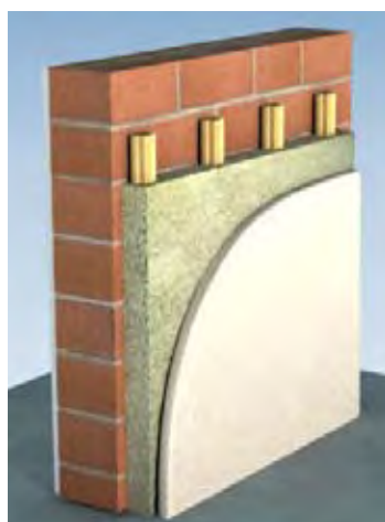
Banchage sur maçonnerie (le mur brique ou agglo sert de coffrage perdu)
