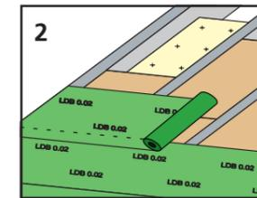
Effectuer la pose à plat du PAVATEX LDB 0.02 directement sur chevrons. Il est obligatoire de le poser sur un isolant en fibres de bois de 4 cm min. Les recouvrements et raccords seront étanchés durablement.
