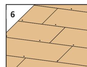
Le PAVATHERM-PLUS / ISOLAIR se fixe provisoirement au moyen de clous ou agrafes disposés dans la partie inférieure du panneau, afin de faciliter la pose du panneau supérieur.
