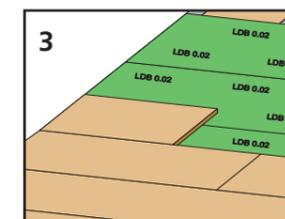
Enfin, le PAVATHERM-PLUS ou l'ISOLAIR se pose à coupe de pierre avec assemblage en rainure languette perpendiculairement aux chevrons, avec la languette orientée vers le faîtage.
