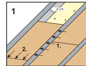
Après avoir découvert la toiture, il est nécessaire d'effectuer un diagnostic de l'état de l'isolant entre chevrons existant. Si celui-ci est détérioré, il est préférable de le remplacer en partie ou complètement par le PAVAFLEX.
