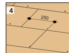
Les jonctions des petites rives verticales ne sont pas obligatoirement réalisées au droit des chevrons. Elles doivent être décalées de 250 mm d'un rang à l'autre.
