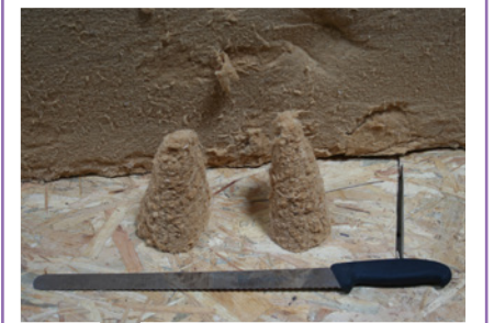
Avec le couteau Isonat, carottage effectué dans un panneau semi-rigide de 200 mm, surprenant !
