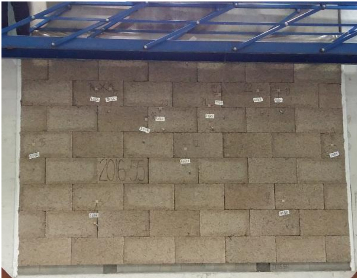
Photo de la face non exposée au feu du mur avant l'essai
