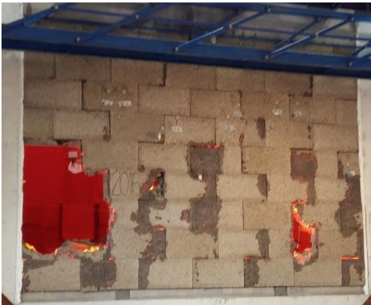
Photo de la face non exposée au feu du mur après essai
