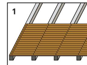
Le complexe PAVATHERM et PAVATHERM-PLUS / ISOLAIR doit être posé par l'extérieur sur un support continu, ex. lambris, panneaux OSB, panneaux contrecollés, panneaux plâtre, etc.
