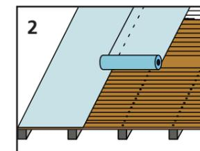
Si le support est en lambris, il est obligatoire de poser un régulateur de vapeur PAVATEX DSB2. Les recouvrements ainsi que les raccords de celui-ci avec les autres éléments de la construction seront étanchés durablement.
