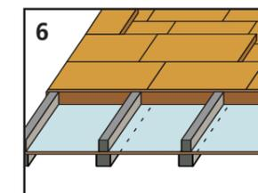
Poser ensuite la deuxième couche de panneaux isolants et écran rigide de sous-toiture combinés PAVATHERM-PLUS ou d'écran rigide de sous-toiture ISOLAIR avec languette vers le faîtage.
