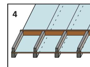
Déterminer le point de départ de l'isolant. Poser les calages de débords de toit avec la planche / le carretet de retenue. Le chant supérieur est aligné à la face supérieure de l'isolant. Ils seront fixés au lambris dans les chevrons.
