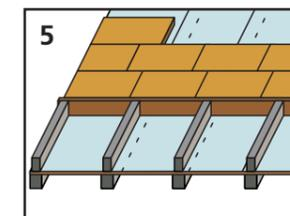
Poser tout d'abord, par empilage et sans fixation, une première couche de panneaux isolants PAVATHERM, en décalant les joints.
