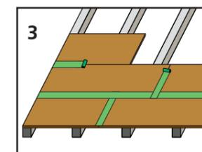
Si le support est formé de panneaux contrecollés ou OSB, le régulateur de vapeur n'est pas obligatoire à condition que les joints des panneaux soient durablement étanchés avec un ruban adhésif (ex. PAVAFIX 60).
