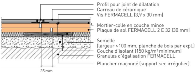
**Liaison avec une cloison sèche FERMACELL.**
