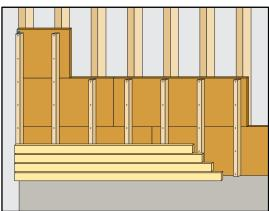
Veillez à ne pas quitter le chantier sans au préalable avoir fixé les contre-lattes avec des vis ou des clous jusque dans la stucture. Les panneaux ISOROOF-NATUR sont garantis 3 mois sans la pose du bardage. Il n'est pas nécessaire de poser un taquet d'étanchéité entre la contre-latte et le panneau ISOROOF-NATUR.
