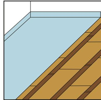
6. Vérifier la nécessité de poser un régulateur ou une barrière de vapeur, avant la pose des lames en bois massif.
