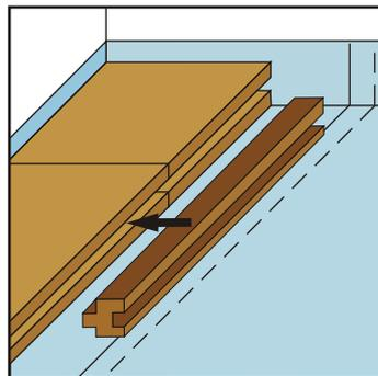
4. Les lattes de bois seront alignées à la surface supérieure des panneaux, afin de pouvoir fixer les lames de plancher.
