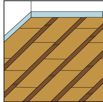
5. Lors de la pose des panneaux PAVATHERM-PROFIL et des lattes de bois, veillez à ne jamais aligner les joints de ceux-ci.
