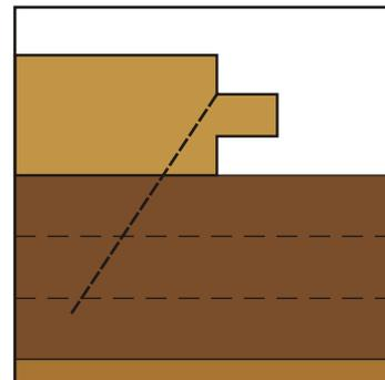
7. Fixer les lames de plancher en bois massif sur les lattes de bois avec des vis, clous ou agraffes, sans que ceux-ci ne dépassent la surface inférieure des lattes.
