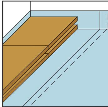
3. Introduire les lattes en bois dans la rainure des panneaux avec un joint de 10 mm contre la paroi et ensuite 5 mm entre chaque latte.
